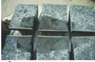
In dieser Flasche ist es bereits lokal zu einer Acetylenzersetzung gekommen.
