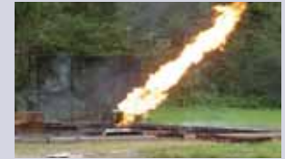
Ansprechen eines Sicherheitsventils.
