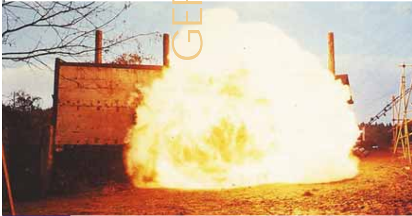
Explosion eines 4-kg-Staub-Luft-Gemisches im Freien (Foto: Bartknecht)
