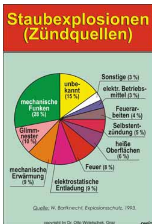
Zündquellen bei Staubexplosionen (nach Bortknecht bzw. Berufsgenossenschaftliches Institut für Arbeitsschutz, St. Augustin).
