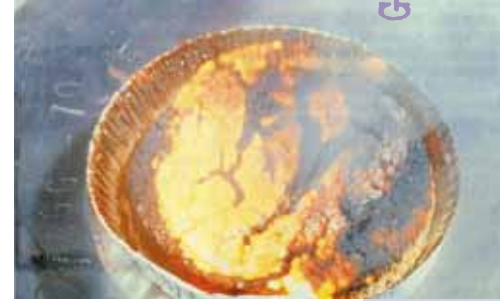
Ein Glimmnest nach einer Staubselbstentzündung.
