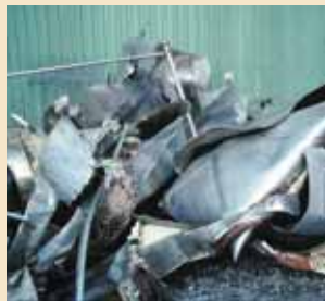
Der total zerstörte Peroxidbehälter.
