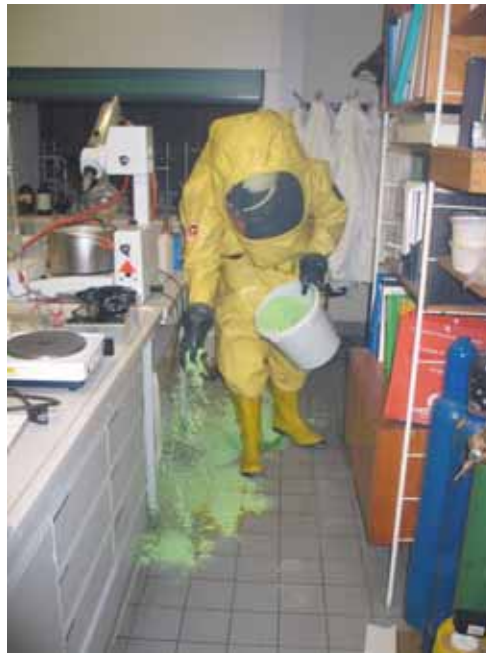
Aufbringen von Säurebindemittel unter Vollkörperschutz (Foto BF Graz).
