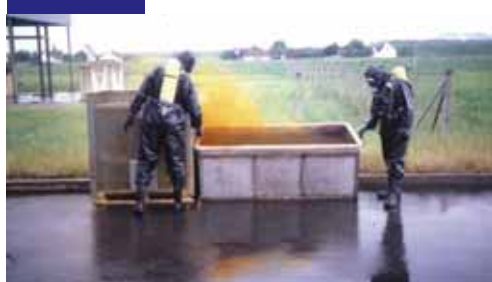
Umfassende Neutralisationsversuche des Autors mit der FF Lebring-St. Margarethen im Jahre 1980. Man beachte die Bildung von nitrosen Gasen (Foto Widetschek).
